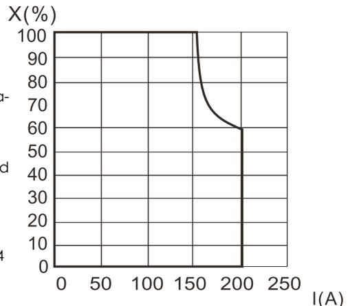
**Warnung: Arbeit in Überlastung ist schädlich für die Schweißmaschine**
