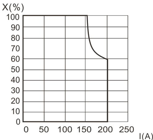
**Attenzione: il lavoro in sovraccarico è nocivo per il generatore di saldatura**
