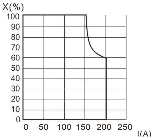
**Upozornenie: Prefaženie zariadenia môže spôsobiť poškodenie zvaracieho zariadenia!**
