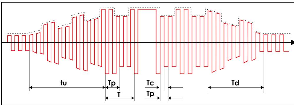
Hegesztőáram és -feszültség változása a hegesztés fázisaiban impulzusos AC AWI módban
