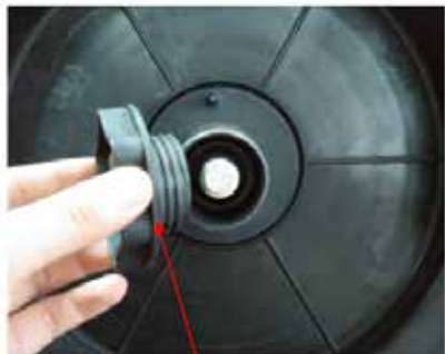
1. Rimuovere la ghiera serra bobina
